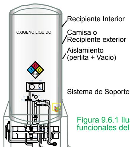
Figura 9.6.1 Ilustra las principales partes funcionales del tanque criogénico.
